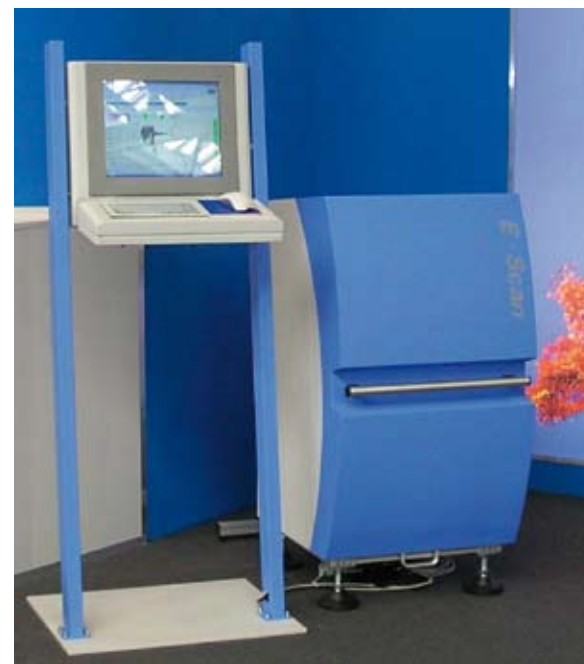
Rip-Scanner potrafi odczytać z tarcicy kilka istotnych parametrów wizualnych, tj. rysunek, układ słojów czy geometria profilu, ale także rozpoznaje wady drewna, np. sęki, pęknięcia, siniznę, zgniliznę, fałszywą twardziel.
