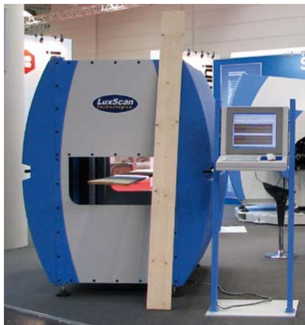
Rip-Scanner potrafi odczytać z tarcicy kilka istotnych parametrów wizualnych, tj. rysunek, układ słojów czy geometria profilu, ale także rozpoznaje wady drewna, np. sęki, pęknięcia, siniznę, zgniliznę, fałszywą twardziel.
